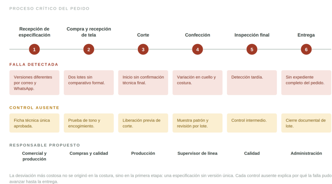
Figura 41 Fallas y controles en el proceso crítico
